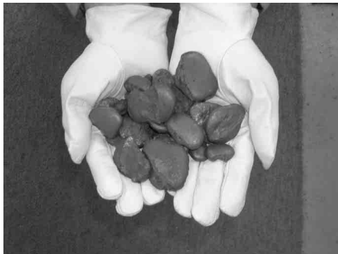
写真 3 パイロットプラントテストで製造した粒鉄 Photo 3 Iron pebbles produced in a pilot plant test
